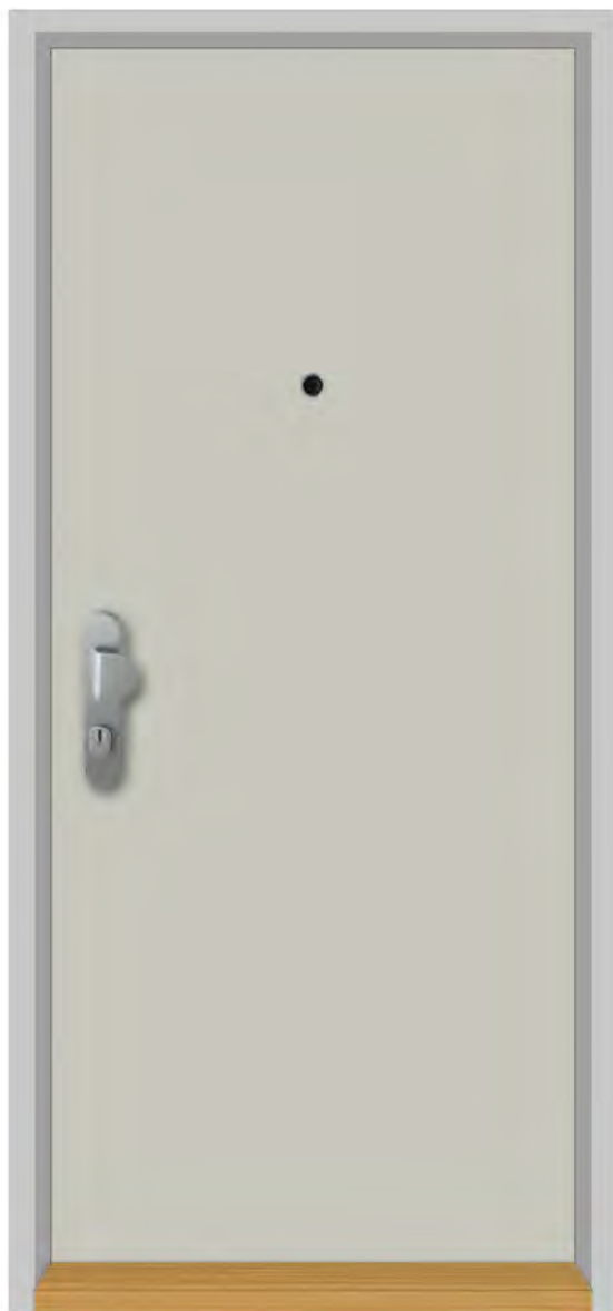
DVEŘE LIGNIS RC3, EI30 DP3 CPL 900/2100 mm, kukátko, práh 3. bezpečnostní třída uvnitř CPL bílá, vně CPL šedá
